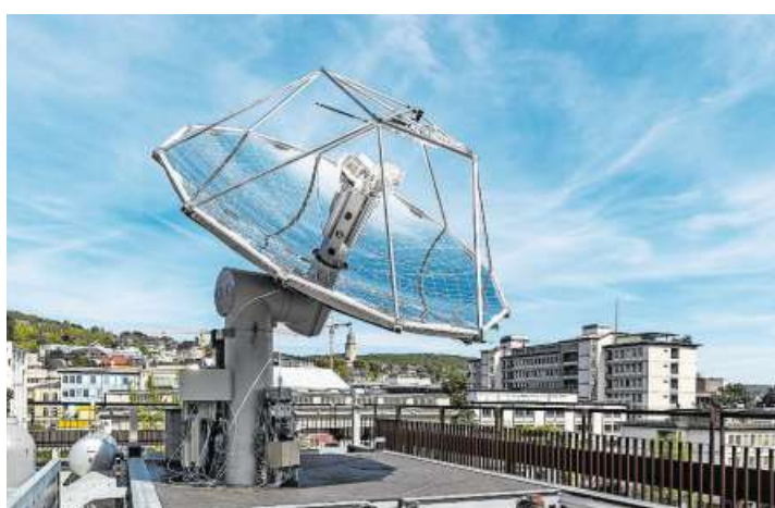
Der Parabolspiegel bündelt das Licht und leitet es in die beiden Reaktoren in der Mitte der Anlage.
